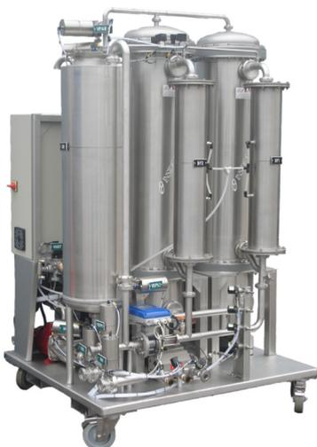
Le mouvement de la crépine filtrante à grande vitesse à proximité d'une crépine fixe crée un effet ultrasonique. Une purge séquentielle permet quant à elle d'éliminer régulièrement les particules indésirables. Ensuite, la membrane céramique vient terminer le travail pour un résultat surprenant.
